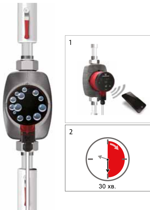
Рис. 7 Видалення повітря з насоса
